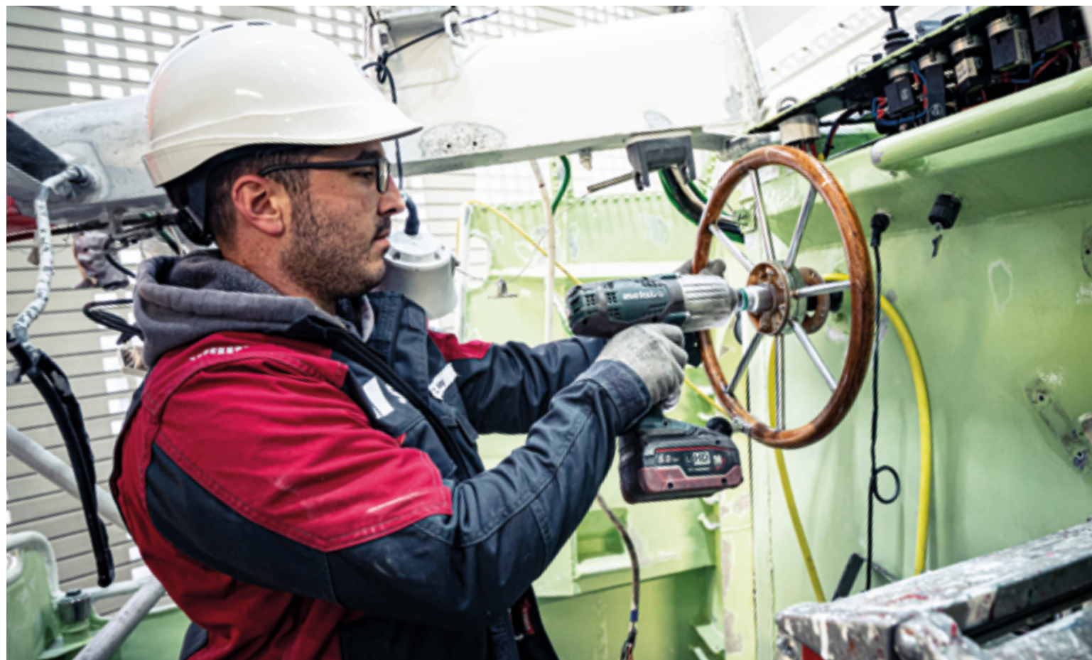
Schlosser Christian Teloy montiert das Ruder des Tochterbootes ab.
