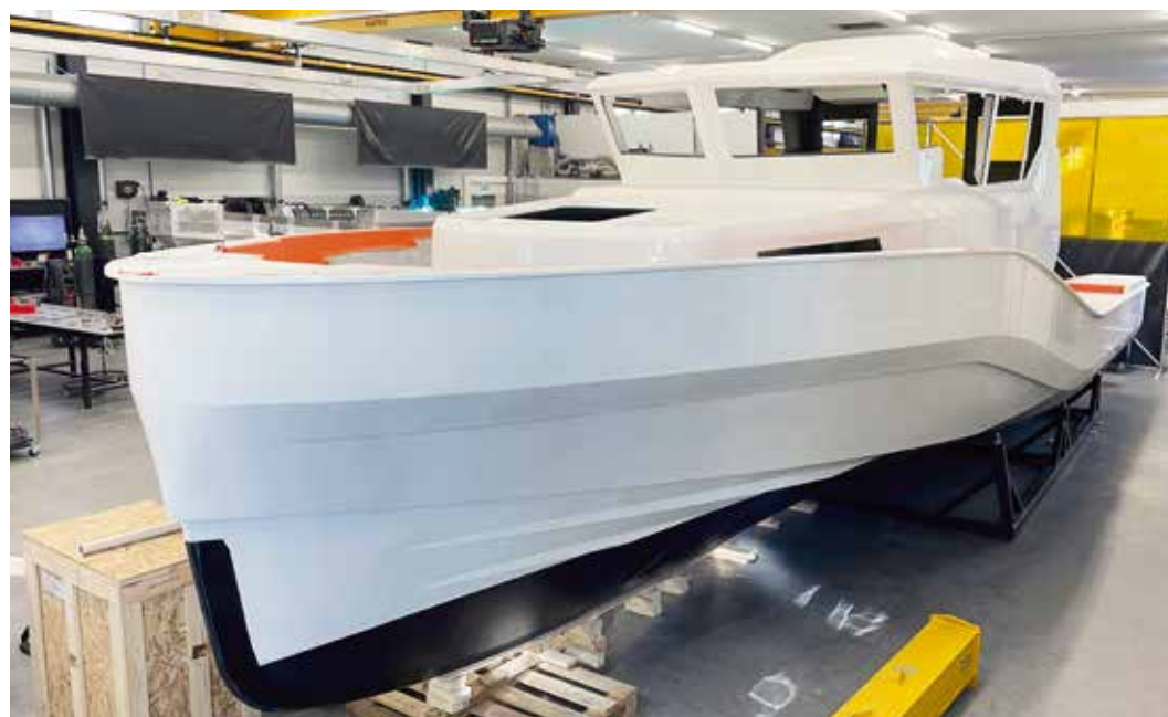
Blick in die Halle der finnischen Spezialwerft WDS Marine in Valko, rund eine Autostunde nordöstlich von Helsinki: Der Rumpf des 12,7-Meter-Seenotrettungsbootes ist weit vorangeschritten. Das parallel dazu entstandene Deckshaus ist bereits probeweise aufgesetzt.
