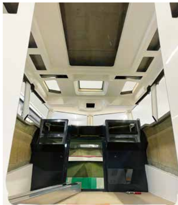
Blick in die Halle der finnischen Spezialwerft WDS Marine in Valko, rund eine Autostunde nordöstlich von Helsinki: Der Rumpf des 12,7-Meter-Seenotrettungsbootes ist weit vorangeschritten. Das parallel dazu entstandene Deckshaus ist bereits probeweise aufgesetzt.
