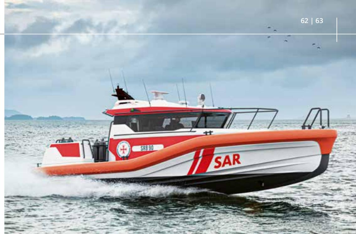
Erste, unverbindliche Visualisierung eines neuen Seenotrettungsbootes: Das voraussichtlich gut zwölf Meter lange Boot verfügt über eine Doppeljet-Anlage mit je 425 PS starken Maschinen, die ihm mehr als 30 Knoten Geschwindigkeit ermöglichen.
