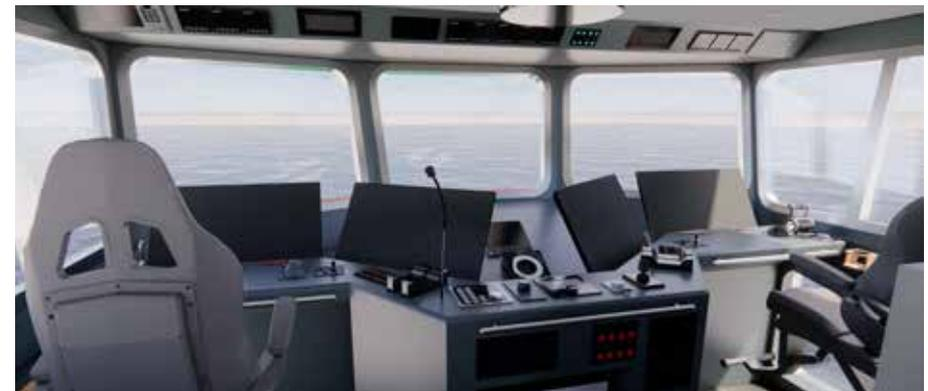
Simulation eines neuen Seenotrettungskreuzer-Typs: Das gut 24 Meter lange Spezialschiff soll einen schlanken Wulstbug und Manövrierfahrstände außen an der Achterkante des Deckshauses erhalten. Auch die Brücke wird nach neuesten Erkenntnissen gestaltet (unverbindliche Visualisierungen).
