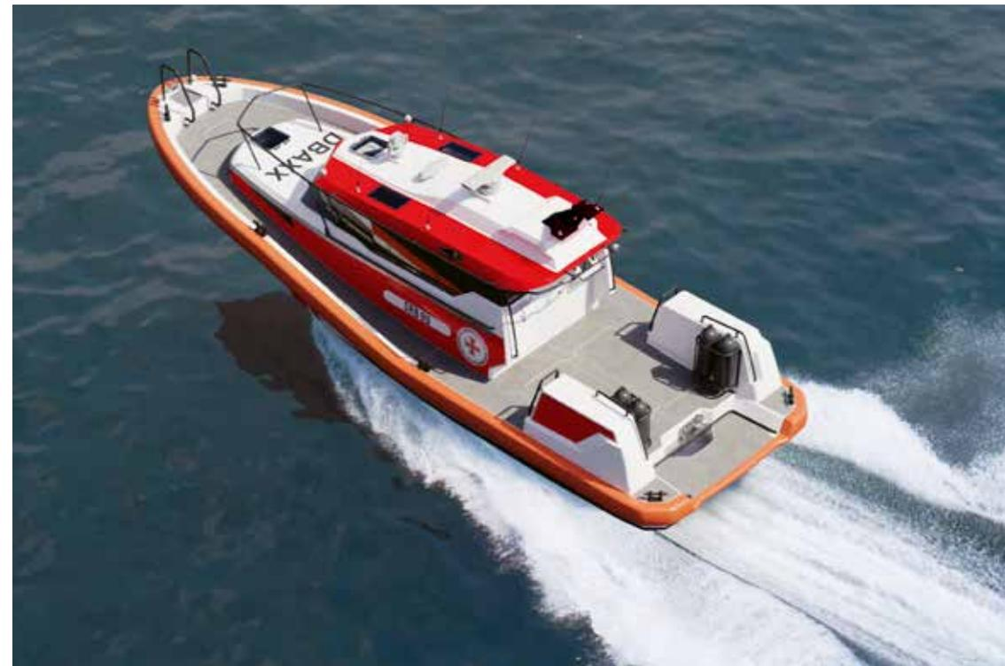
schaften getestet. Aus diesen Erfahrungen entstand in enger Entwicklungszusammenarbeit mit Arctic Airboats aus Finnland (8,9-Meter- und 8,4-Meter-Klasse) als Optimum ein eigener neuer Typ. Das neue Seenotrettungsboot wird gut zwölf Meter lang sein. Ein Doppeljet-Antrieb mit bewährten Cummins-Motoren sorgt für mehr als 30 Knoten Höchst- und gut 25 Knoten Marschgeschwindigkeit, in Abhängigkeit von den Wetter- und Seegangsbedingungen.
