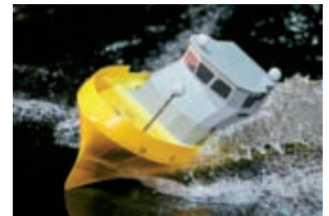
Seegangversuche im Modell für den Nachfolger der 27,5-Meter-Klasse: Die DGzRS plant, den ersten Seenotkreuzer dieses neuen Typs 2015 in Dienst zu stellen.
