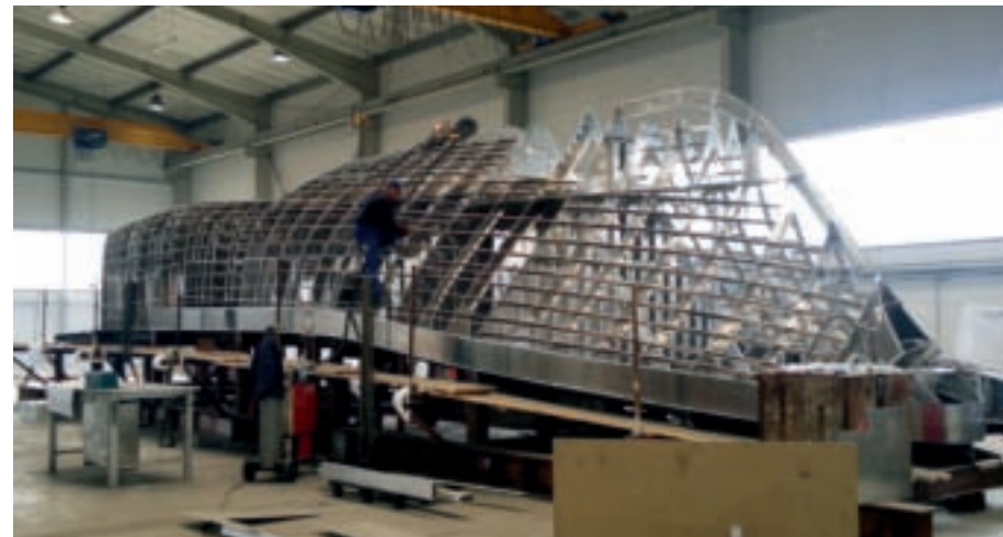
Baubeginn für den vierten Seenotkreuzer der 20-Meter-Klasse im Herbst 2012. Die bewährte Netzspanntenbauweise verleiht dem Rumpf besondere Festigkeit. Auf Wunsch fährt Ihr Name an Bord mit (siehe Kasten Seite 74).
